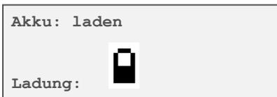
Nach Abschluss des Ladevorganges schaltet sich das Gerät ab. Soll das Gerät vor dem Abschluss des Ladevorgangs wieder benutzt werden, kann die normale Betriebsart jederzeit durch Betätigen der Ein-/Ausschalttaste auf der Frontplatte wieder gestartet werden. Durch Ausschalten der Netzversorgung wird der Ladevorgang unterbrochen.
