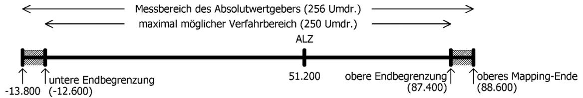
Hier wurde das obere Mapping-Ende vom Wert 102.400 auf den Wert 88.600 verringert. Somit liegt ein höherer Anteil des möglichen Verfahrensbereiches im Bereich unterhalb 51.200 und ein kleinerer Anteil im Bereich oberhalb 51.200.
