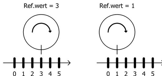
Der Referenzierungswert wird entweder direkt geschrieben oder durch Setzen der Istposition.
