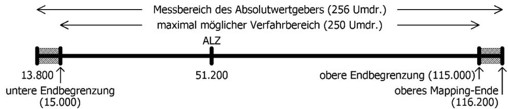
Hier wurde das obere Mapping-Ende vom Wert 102.400 auf den Wert 116.200 erhöht. Somit liegt ein höherer Anteil des möglichen Verfahrensbereiches im Bereich oberhalb 51.200 und ein kleinerer Anteil im Bereich unterhalb 51.200.
