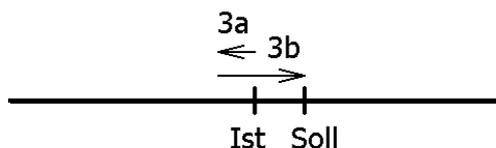
Die maximale Länge dieser Strecke ist die Schleifenlänge. Wenn sich der Sollwert um mehr als die Schleifenlänge vom aktuellen Istwert unterscheidet wird dieser direkt angefahren.
