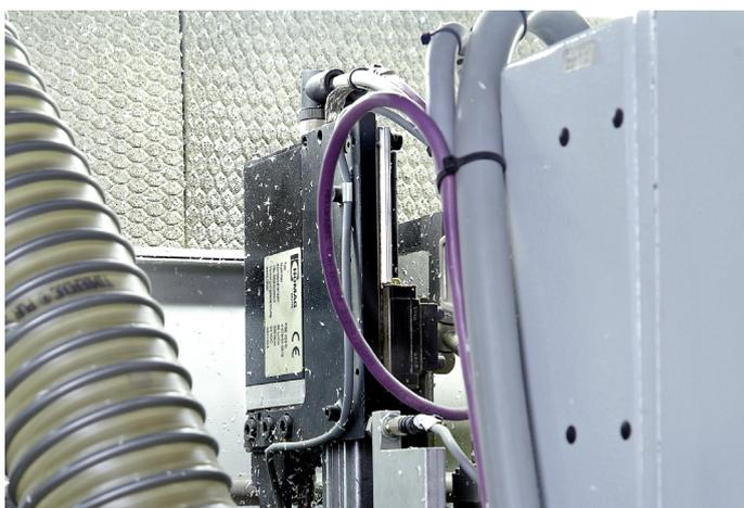
Fig. 5: I sistemi di posizionamento PSE di halstrup-walcher realizzano in maniera affidabile il cambio di formato — da oltre 10 anni.
