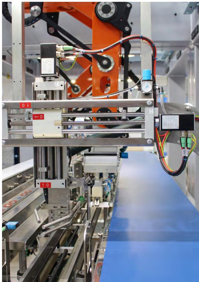
Abb. 4: Formatumrüstungen in Verpackungsmaschinen lassen sich mit Positioniersystemen auf Knopfdruck schnell und exakt umsetzen.
