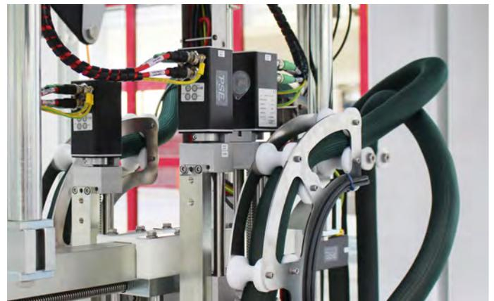
Abb. 2: Für die Formateinstellung verwendet Schubert die Positioniersysteme der halstrup-walcher GmbH.
