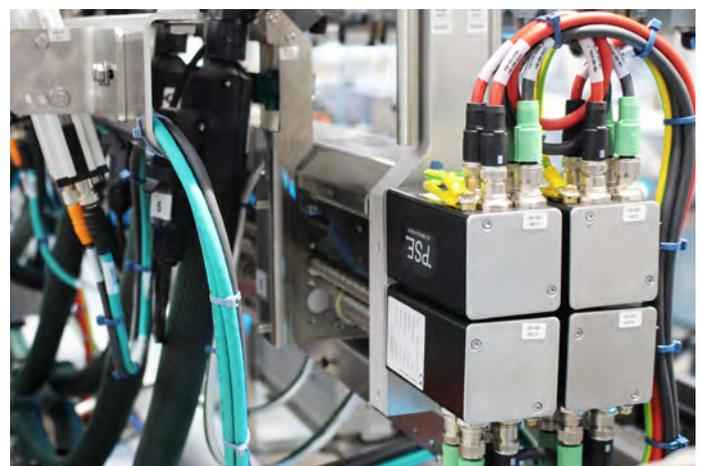
Abb. 5: Automatische Einstellung des Leimauftragsmoduls in der Kartonklebung: Hier muss ein exakter Auftrag des Leims an der richtigen Stelle gewährleistet sein.
