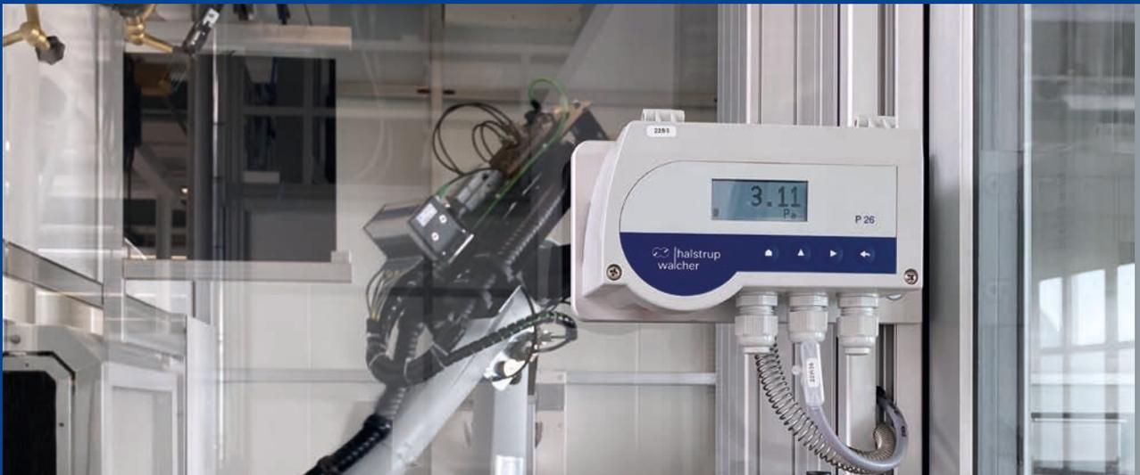
*Anwendung eines P 26 zur Überwachung und Steuerung der Schutzbarriere in der aseptischen Produktion von Impfstoffen.*
