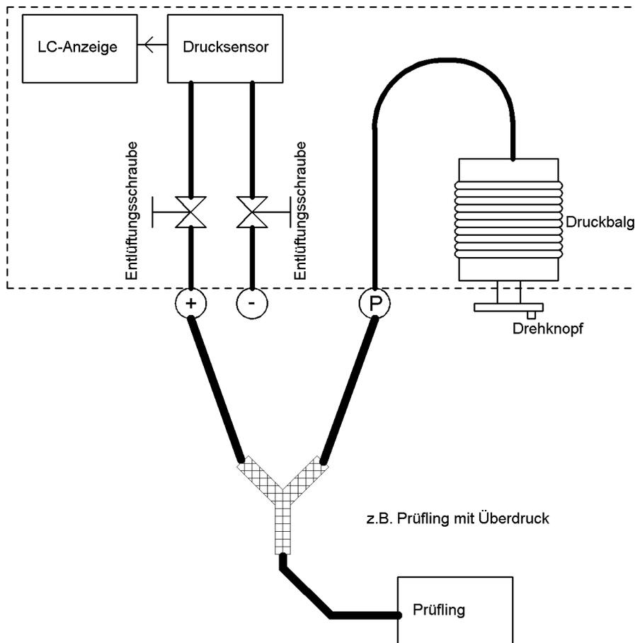
**Abbildung 1 Pneumatischer Anschluss**
