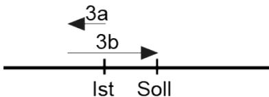
Nach Erreichen der Sollposition wird diese Position mit dem internen Absolutencoderstand verglichen. Bei einer Abweichung wird das Status-Bit „Fehler“ gesetzt.
