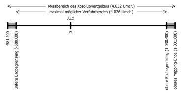
Hier wurde das obere Mapping-Ende vom Wert 806.400 auf den Wert 1.031.600 erhöht. Somit liegen ein höherer Anteil des möglichen Verfahrbereichs im positiven Bereich und ein kleinerer Anteil im negativen Bereich.
